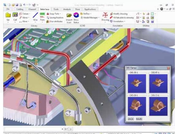
Simulation elektromechanischer Produkte und Optimierung deren Konstruktion für die Fertigung mit Creo Elements/Direct Cabling.
